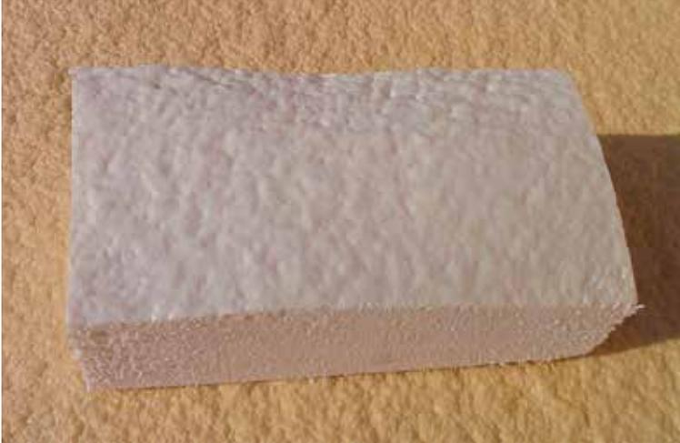
La muestra de material de techado de espuma en aerosol muestra la densidad uniforme lograda con Solstice LBA en el sistema de Techado combinado moderno.
